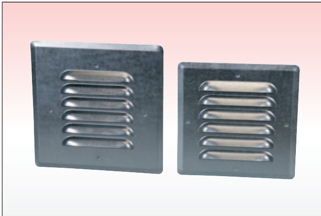
Fyrkantigt fasadgaller i galv. plåt. Avsett för trä/skivfasad Ø80 mm. Utvändigt 125x125 mm. Ø100 mm. Utvändigt 145x145 mm Ø100 mm. Utvändigt 155x165 mm. (ROT)
