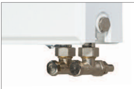
Avstängningsventil, vinkel. Finns i flera olika fabrikat för bl.a: 12 och 15 cu 16x2,0 och 16x2,2 Alu/Pex Byggmått Comap, A529037: radiator-centrum rör: 44 mm
