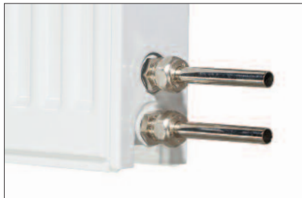
Anslutningskopplingar. 12 och 15cu 16x2,0 och 16x2,2 Alu/Pex
